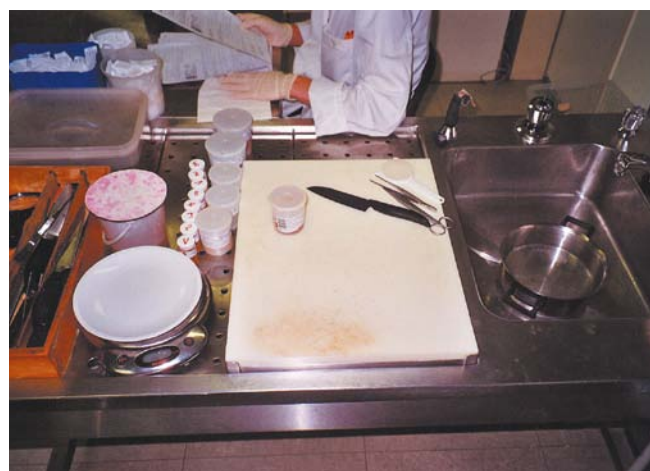
Bild 3 Zuschneideplatz mit Lochblechabsaugung im pathologischen Labor
