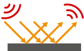
Abb. 25 Absorption und Reflexion von Schall
