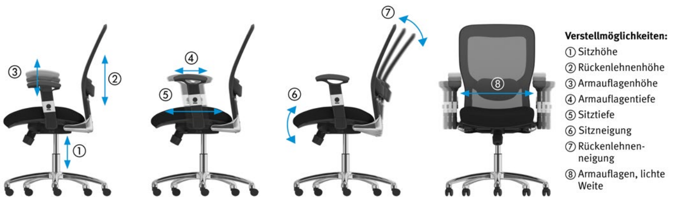
Abb. 12 Verstellmöglichkeiten an einem Büroarbeitsstuhl
