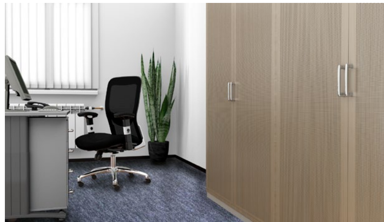
Abb. 24 Möglichkeiten zur Verbesserung der Raumakustik: Schallabsorbierende Lamellenstores und Möbel mit Schallabsorptionsfläche sowie schallabsorbierender Teppichboden
