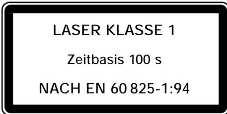
Lasereinrichtungen der Klassen 2 bis 4 müssen nach Abschnitt 5.8 EN 60 825-1 auf einem Hinweisschild durch Angaben über die maximalen Ausgangswerte der Laserstrahlung, der Impulsdauer (falls zutreffend) und der ausgesandten Wellenlänge(n) beschrieben werden. Diese Angaben können in einem Hinweisschild zusammen mit der Angabe der Klasse oder in einem separaten Hinweisschild aufgenommen werden.
