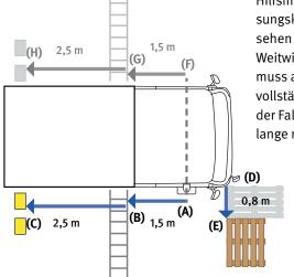
Punkten und in bestimmten Abständen rund um das Fahrzeug ausgelegt bzw. aufgestellt werden. Danach setzt sich der Fahrer ins Führerhaus und passt die Spiegeleinstellung so an, dass die Hilfsmittel in den auf der Unterweisungskarte vorgegebenen Bereichen zu sehen sind. Beispielsweise gilt für den Weitwinkelspiegel rechts "Anlegeleiter muss am unteren Rand des Spiegels vollständig zu sehen sein." Ist das nicht der Fall, muss lediglich der Spiegel so lange nachjustiert werden, bis die Lei-
